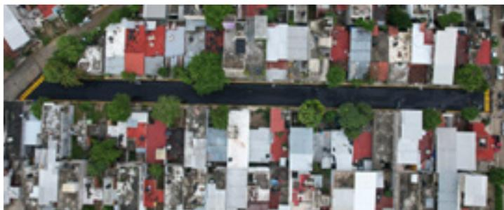
"Rehabilitación de la calle 3 del Fraccionamiento San Isidro de esta ciudad", con el reencarpetado a base de pavimento asfáltico.
